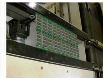
全はんだ接合ポイントの状態を自動検査
