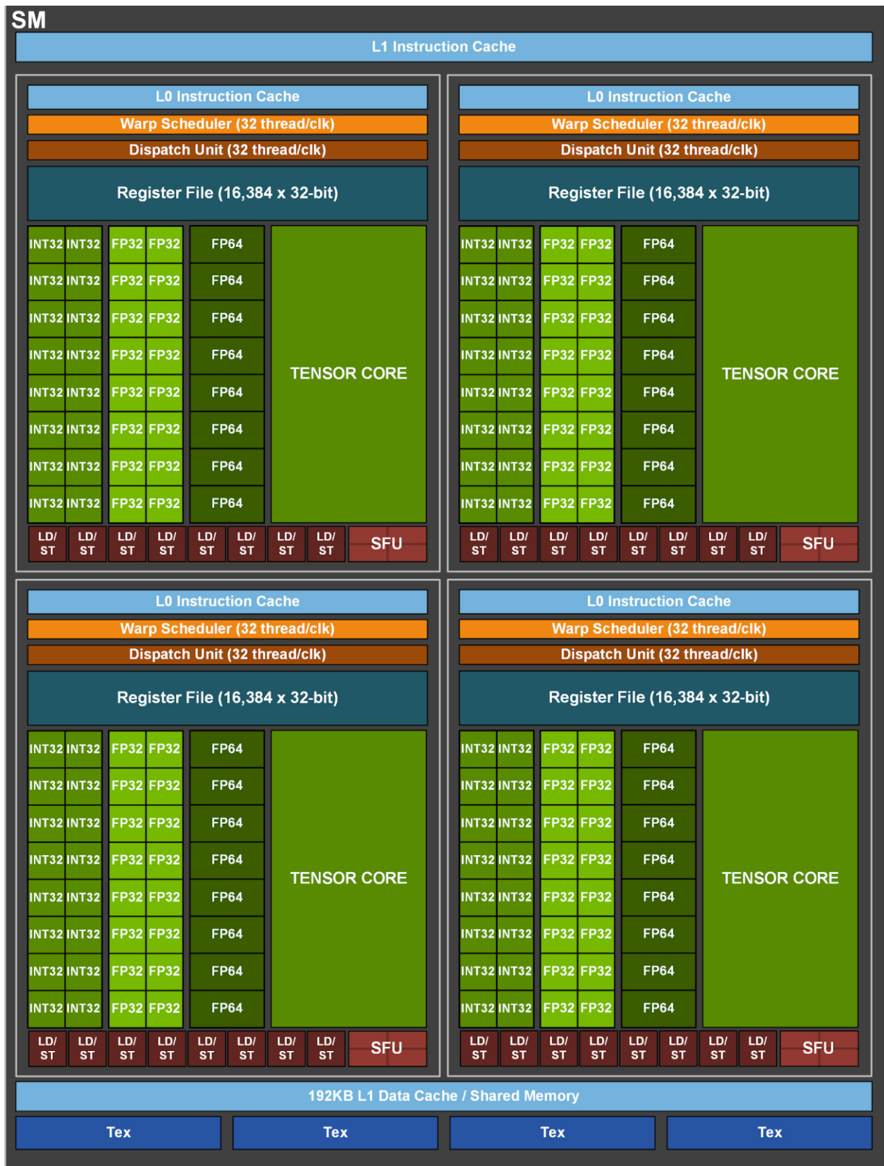
図 5. GA100 ストリーミング マルチプロセッサ (SM)
